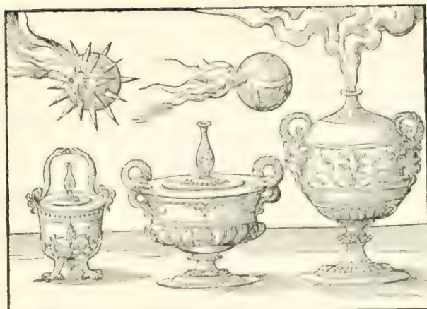
Abb. 40. Gefäße zur Dampfentwicklung. Vitruv, 8. Buch nach Riss (Rivius). Nürnberg 1548, deutsch.
